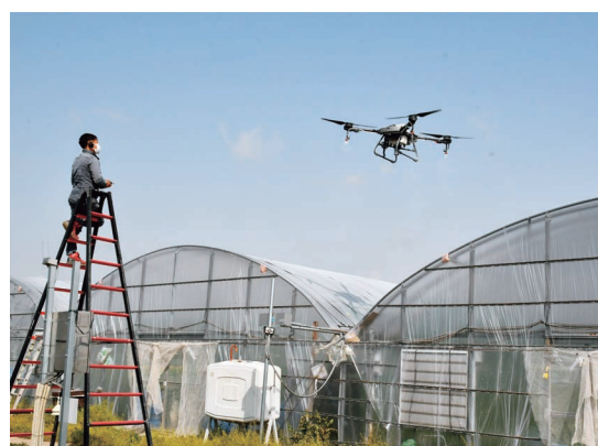
オペレーターにより遮光材散布を行うドローン
