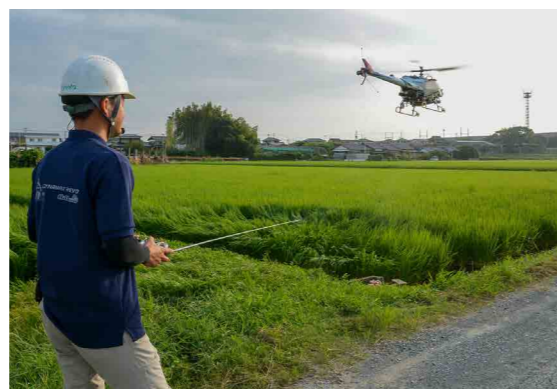
高品質な米生産のために行われる無人ヘリでの防除作業
